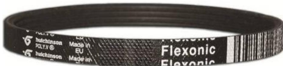
Notre courroie de transmission Flexonic® avec câblé élastique polyamide, obtenue par moulage, offre d'excellentes propriétés mécaniques. Notre solution s'installe sur des systèmes à entraxe fixe permettant tous types d'architectures de la transmission de puissance (montage serpentine, entraînement d'un récepteur par le dos). Elle maintient une tension stable dans le temps.
