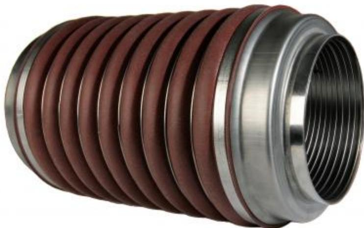
Notre solution Linkeo® est un découpleur d'échappement extrêmement flexible, conçu pour atténuer au maximum les vibrations et les déplacements générés par le moteur des machines offroad. Grâce à ses hautes performances thermiques, notre solution accélère la mise en température du filtre à particules et récupère le désalignement de la ligne d'échappement. Elle réduit ainsi la fatigue des pièces mécaniques sur la ligne et évite les ruptures en vibration.
