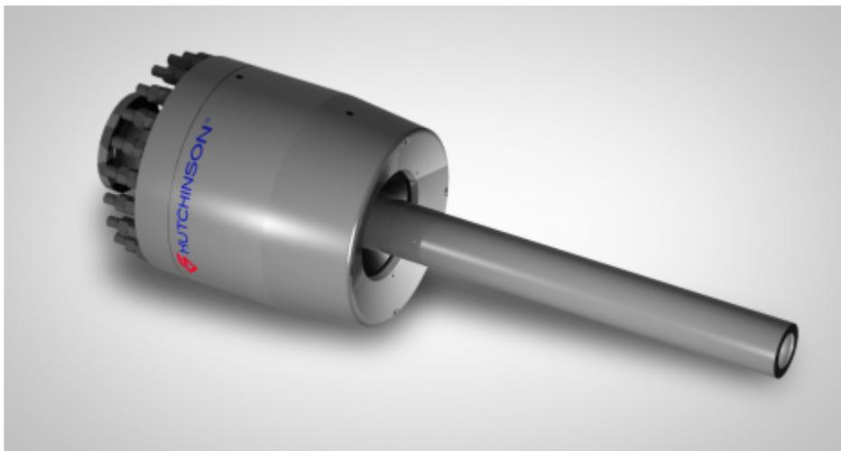
Nuestras juntas flexibles conectan los conductos catenarios que se extienden desde las plataformas hasta la red de tuberías submarinas. Se diseñan a medida en función de la dinámica relativa entre soportes flotantes y risers, así como de las características del fluido transportado. Permiten que la parte superior del conducto, sometida a las cargas de fatiga más importantes, sea capaz de resistir durante toda la vida útil de la plataforma
