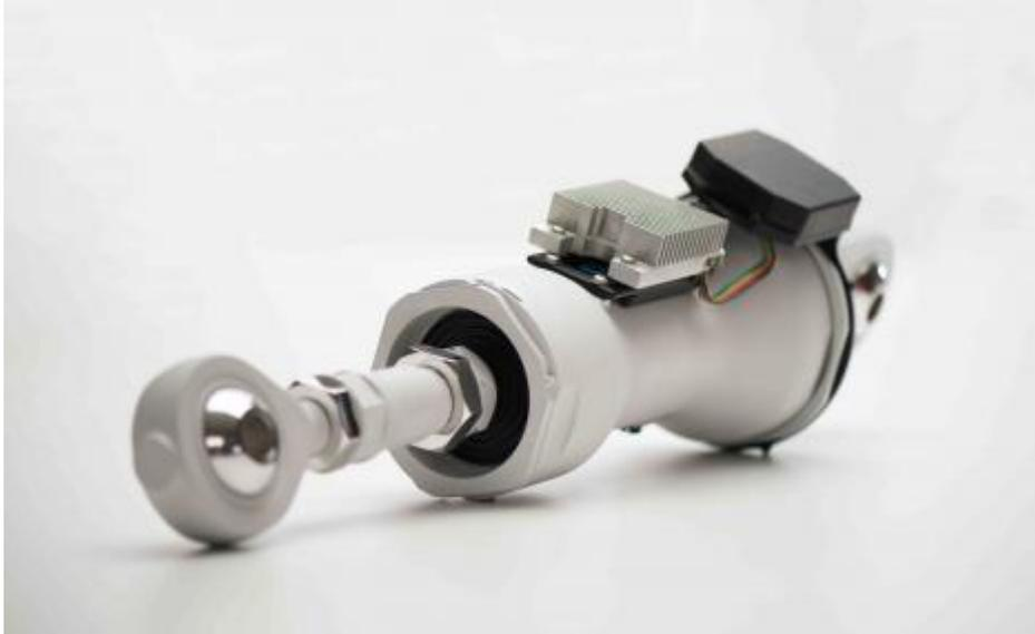
Mediante nuestro sistema de seguimiento de estado y uso (HUMS) integrado, los sensores a bordo de los adaptadores de frecuencia para helicópteros miden el desplazamiento, el esfuerzo, la presión y la temperatura. Los datos recopilados se registran y analizan en vuelo, lo que permite evaluar el estado del componente y registrar datos en condiciones reales de funcionamiento.
