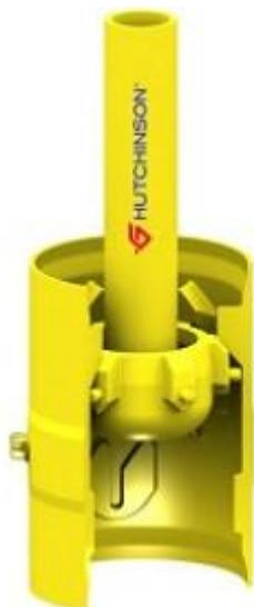
Nuestros conectores con autobloqueo han sido diseñados para conectar y articular risers híbridos y plataformas de anclaje mediante tendones. Su instalación es fácil y garantizan un anclaje seguro y fiable a más de 1500 metros de profundidad sin ningún tipo de asistencia. Además, reducen la tensión de flexión y no requieren mantenimiento durante su vida útil.
