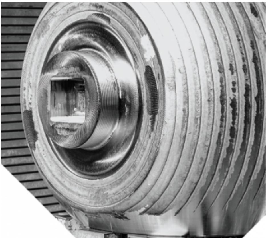
Bolas revestidas diseñadas, fabricadas y soldadas de acuerdo con los requisitos de nuestros clientes en todo el mundo. La soldadura de recubrimiento se obtiene poniendo sobre la superficie del material acero al carbono y dos o más capas de material protector. Normalmente se añade Inconel o acero inoxidable F316, con gran resistencia a la corrosión de fluidos o gases agresivos.
