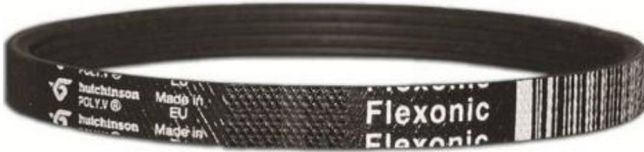
Unser hochleistungsfähiger Antriebsriemen Flexonic® ist mit einem elastischen Polyamid-Zugträger ausgestattet. Zur Gewährleistung bestmöglicher Qualität setzen wir ein Formverfahren ein. Unser Riemen kann bei Antrieben mit festem Achsabstand eingesetzt werden; jede Anordnung des Antriebs wird so ermöglicht, beispielsweise Serpentinantrieb oder Antrieb über den Riemenrücken, wobei die Spannung konstant gehalten wird.
