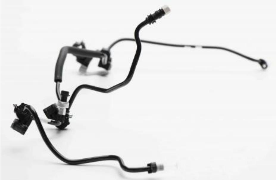
Statt einer Kombination aus Rohr und Schlauch wird hier die Flüssigkeitsleitung im Klimakreislauf durch eine TP-Rohrleitung ersetzt. Die Vorteile für unsere Kunden sind z.B. das reduzierte Gewicht und die Platzersparnis durch den Verzicht auf Schläuche und Verpressungen.
