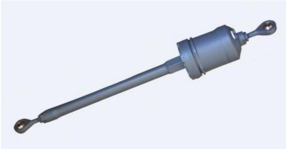
Unsere Schwenkdämpfer werden an Helikopter-Rotorköpfen installiert, entweder zwischen Rotorwelle und Rotorblatt oder zwischen zwei aufeinanderfolgenden Rotorblättern. Als wichtige Rotorkomponenten stellen sie die dynamische Stabilität des Flugzeugs bei allen Betriebsbedingungen sicher. Diese Lösungen sind besonders für die Prävention von Boden- und Luftresonanz von entscheidender Bedeutung.
